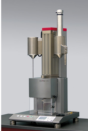
Fließprüfgerät Aflow zur MFR- und MVR-Messung
